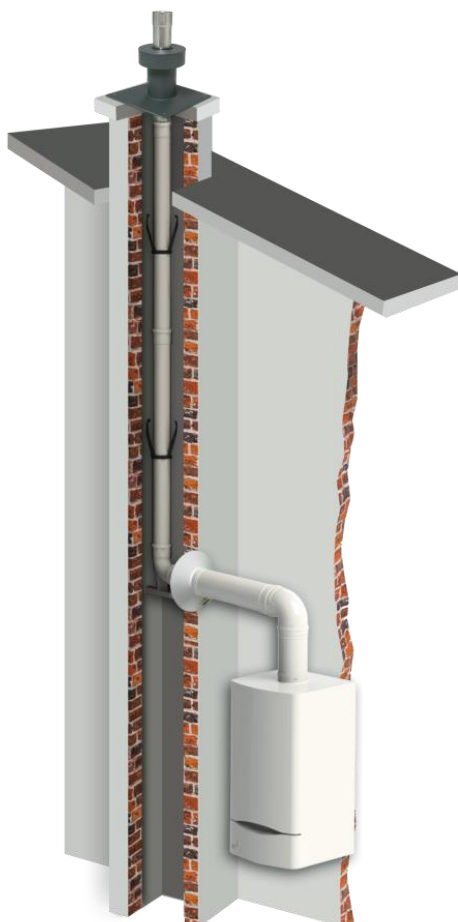
Schemat systemu z poborem powietrza z szachtu kominowego
